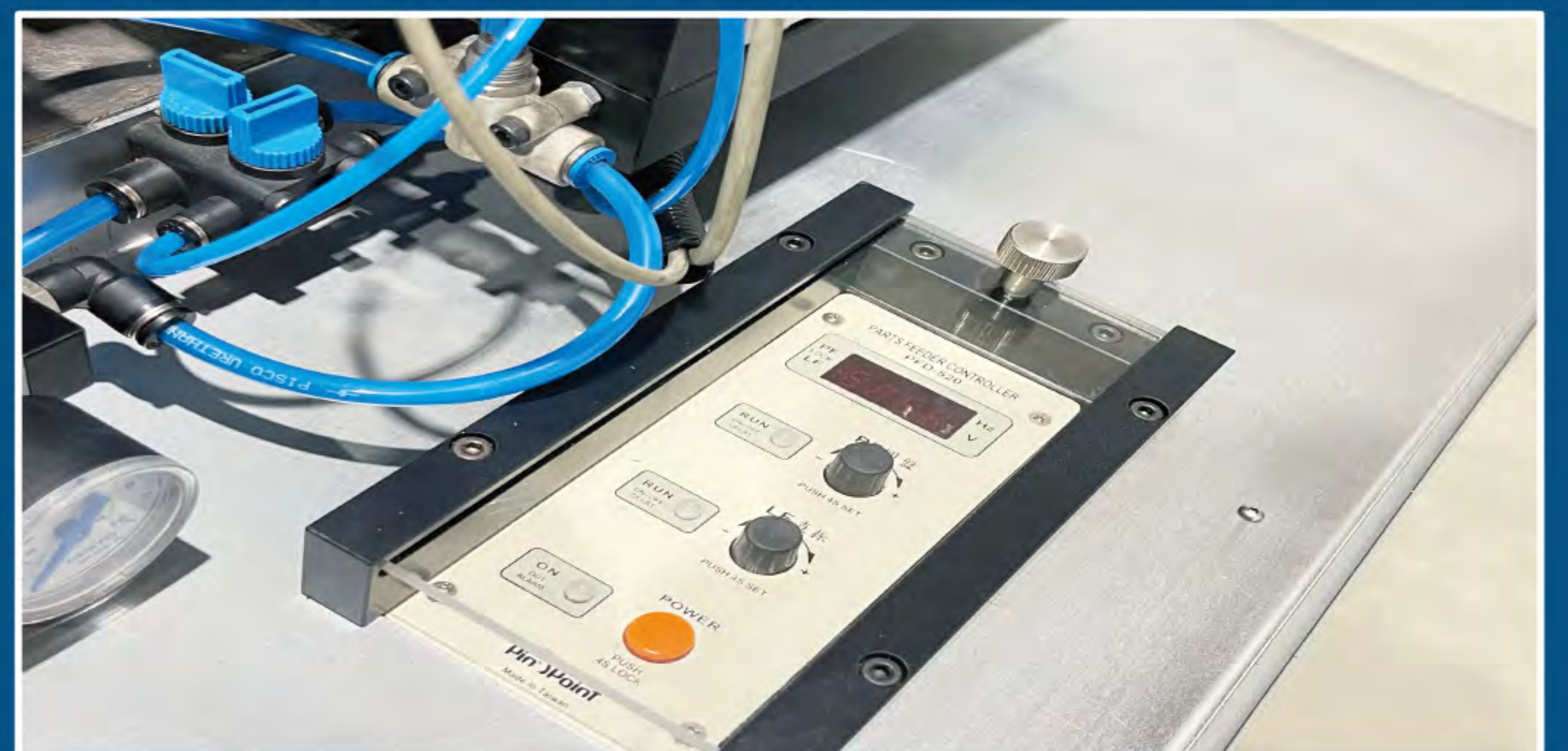
◎ 震動盤控制面板 Vibration feeder control panel
